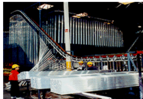
アルミ形材 縦吊シャワーライン
